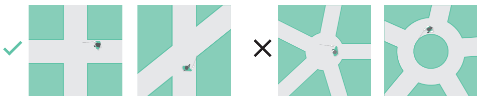
Różne sposoby projektowania układów komunikacyjnych. Po prawej stronie układy utrudniające orientację osobom z niepełnosprawnością wzroku
