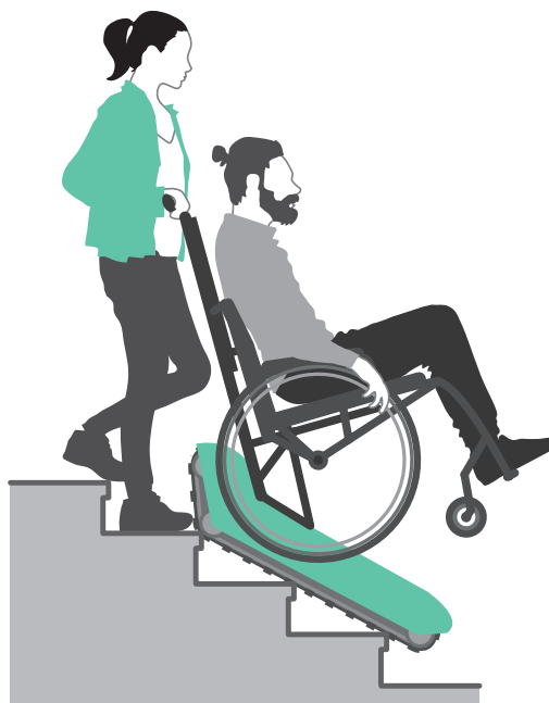
Schodolaz. Urządzenie niezalecane do stosowania w budynkach użyteczności publicznej
