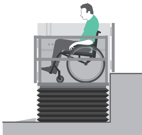
Podnośnik pionowy z kołnierzem gumowym zabezpieczającym przed wejściem pod urządzenie
